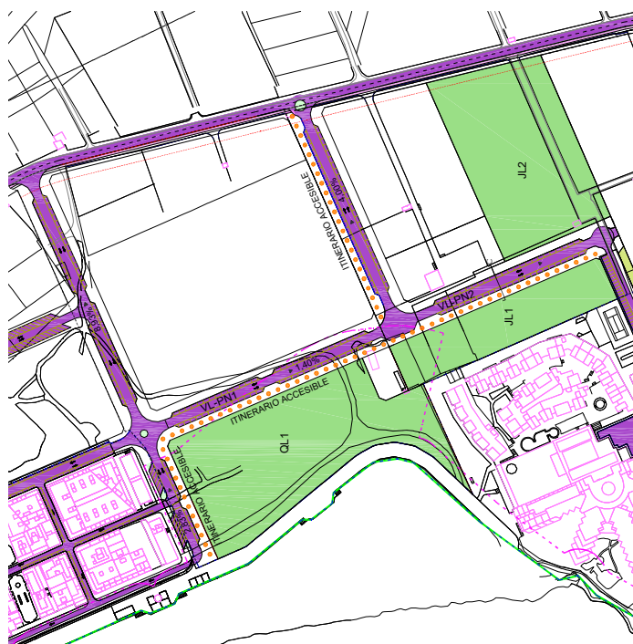
Figura 34. Itinerario alternativo accesible en la articulación con Puerto Naos
